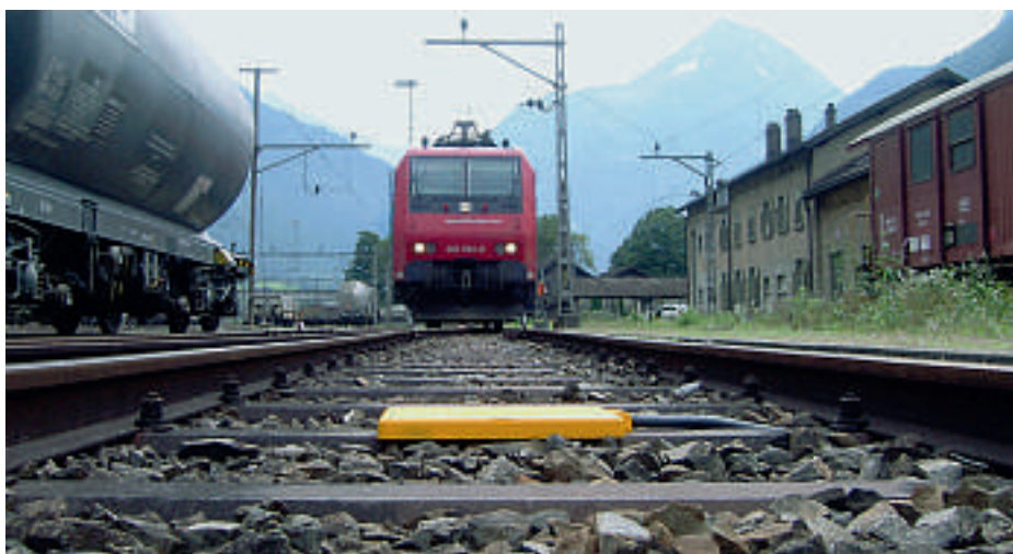
Herannahender Zug und gelbes Zugüberwachungsmodul (Balise) im Schienenbett
