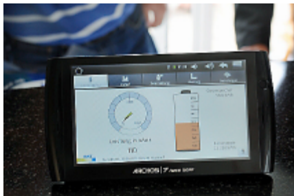
Das Smart Meter zeigt an, wie viel Strom verbraucht wird. Foto: Doris Fanconi
